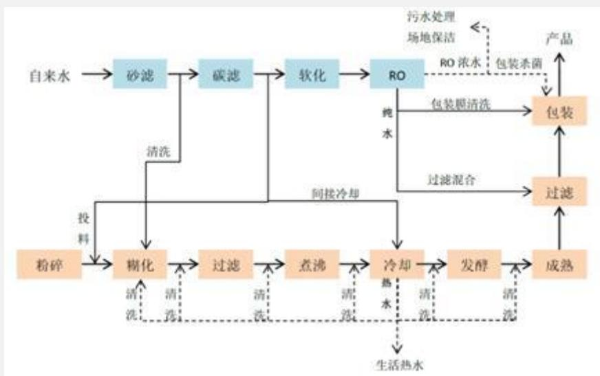
图 17 青岛啤酒工艺水串联回用示意图
