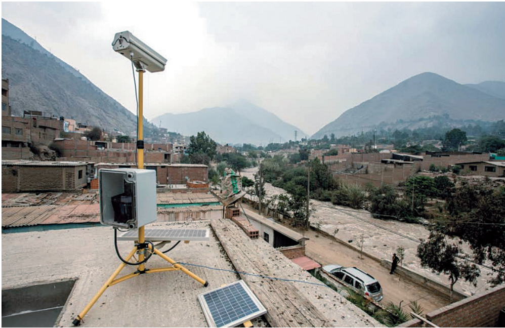
图 5-7 卢里甘乔—乔西卡的太阳能监测站，用于测量温度、土壤湿度、河流活动和降雨情况，内置的通信模块可将数据传送至社区
